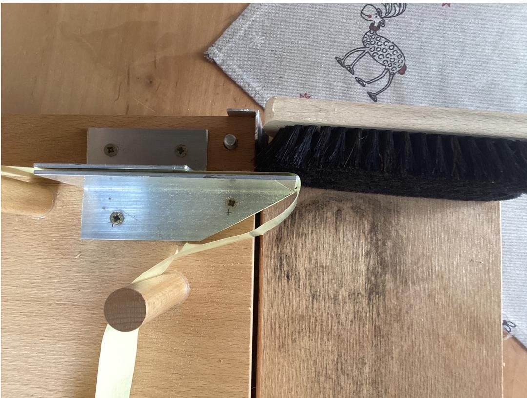
Erst wenn alles montiert ist würde ich den Winkel für die Bürsten setzen. Der ist abhängig davon, wie dick die Bürsten sind und wo genau das Etikett den Winkel verlässt.
