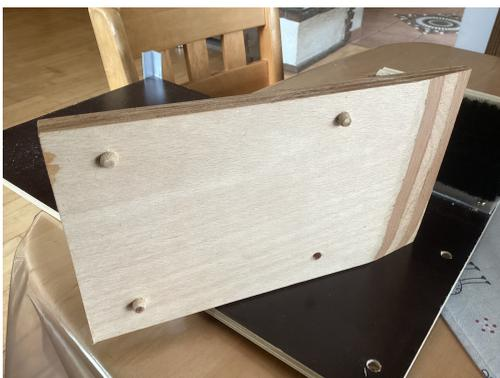
Vor die Bürsten kommt eine Multiplexplatte 15,5 x 26,5 cm, 16mm stark. Ich habe sie an der Oberen Kante auf der Unterseite etwas schräg gehobelt, damit sie über den Winkel passt. Feststellen auf der Grundplatte mache ich nur über drei Holzdübel. die Platte dient dazu, die Höhe des Etiketts zu variieren. Für Flaschen bietet es sich z.B. an, die Platte beim Etikettieren zu entfernen.
